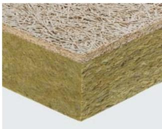
Pannello isolante termico ed acustico composito, costituito da uno strato in lana di legno sottile (larghezza 2 mm) di abete rosso mineralizzata e legata con cemento Portland bianco, sp. 10 mm, accoppiato ad uno strato di lana di roccia conforme alla norma UNI EN 13162. Conforme alla norma UNI EN 13168. CELENIT L2AB è certificato PEFC™. Disponibile anche con certificazione FSC®.
