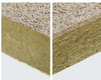
Pannello isolante termico ed acustico composito in Euroclasse A2-s1, d0 costituito da due strati (sp. 5 mm ciascuno) in lana di legno sottile (larghezza 2 mm) di abete rosso mineralizzata e legata con cemento Portland bianco e polvere minerale, accoppiato ad uno strato di lana di roccia conforme alla norma UNI EN 13162. Conforme alla norma UNI EN 13168. CELENIT L3AB è certificato PEFC™. Disponibile anche con certificazione FSC®.
