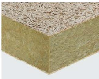
Pannello isolante termico ed acustico composito, costituito da due strati (sp. 5 mm ciascuno) in lana di legno sottile (larghezza 2 mm) di abete rosso mineralizzata e legata con cemento Portland bianco, accoppiato ad uno strato di lana di roccia conforme alla norma UNI EN 13162.
