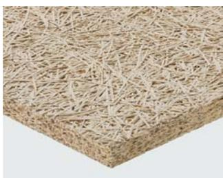
Pannello isolante termico ed acustico, in lana di legno sottile (larghezza 2 mm) di abete rosso mineralizzata e legata con cemento Portland bianco. Conforme alla norma UNI EN 13168 e UNI EN 13964. Certificato da ANAB-ICEA e natureplus per la ecocompatibilità dei materiali e del processo produttivo. CELENIT AB è certificato PEFC™. Disponibile anche con certificazione FSC®.
