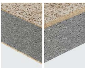
Pannello isolante termico ed acustico composito, costituito da due strati (sp. 5 mm ciascuno) in lana di legno sottile (larghezza 2 mm) di abete rosso mineralizzata e legata con cemento Portland bianco, accoppiato ad uno strato interno di polistirene espanso sinterizzato additivato con grafite, conforme alla norma UNI EN 13163. Conforme alla norma UNI EN 13168. CELENIT G3AB è certificato PEFC™. Disponibile anche con certificazione FSC®.
