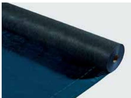
Freno al vapore a tre strati, da posizionare sul tavolato, sotto l'isolante, con resistenza meccanica elevata, doppia idrorepellenza, resistente ai raggi UV, a tenuta d'aria. Prodotto con sistema HMCC.
