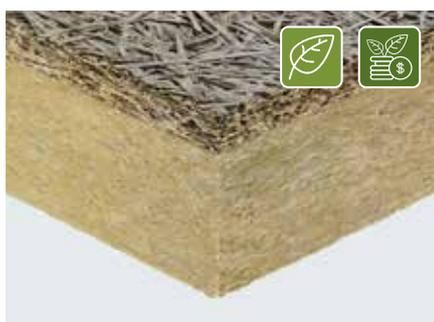
Pannello isolante termico ed acustico composito, specifico per l'applicazione a cappotto, costituito da uno strato in lana di legno di abete rosso mineralizzata e legata con cemento Portland grigio, spessore 25 mm, accoppiato ad uno strato di lana di roccia conforme alla norma UNI EN 13162. Conforme alla norma UNI EN 13168. CELENIT L2/C è disponibile con certificazione FSC®.
