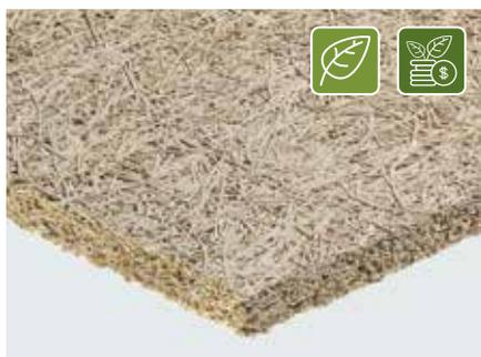
Pannello isolante termico ed acustico, in lana di legno extra sottile di abete rosso mineralizzata e legata con cemento Portland bianco. Larghezza lana di legno: 1 mm. Pannelli di alta qualità per sistemi di design e assorbimento acustico. Conforme alla norma UNI EN 13168 e UNI EN 13964. Certificato da ANAB-ICEA e natureplus per la ecocompatibilità dei materiali e del processo produttivo. CELENIT ABE è certificato PEFC™. Disponibile anche con certificazione FSC®.
