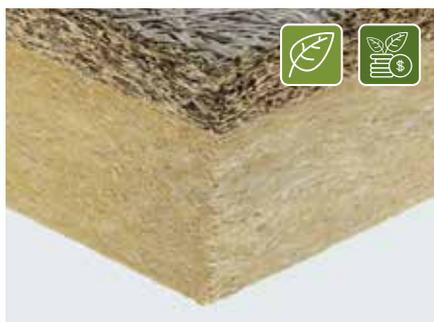
Pannello isolante termico ed acustico composito, costituito da uno strato in lana di legno di abete rosso mineralizzata e legata con cemento Portland grigio, spessore 50 mm, accoppiato ad uno strato di lana di roccia conforme alla norma UNI EN 13162. Conforme alla norma UNI EN 13168. CELENIT L2 è disponibile con certificazione FSC®.
