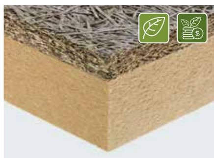
Pannello isolante termico ed acustico composito, specifico per l'applicazione a cappotto, costituito da uno strato in lana di legno di abete rosso mineralizzata e legata con cemento Portland grigio, spessore 25 mm, accoppiato ad uno strato di fibre di legno conforme alla norma UNI EN 13171. Conforme alla norma UNI EN 13168. CELENIT F2/C è disponibile con certificazione FSC®.
