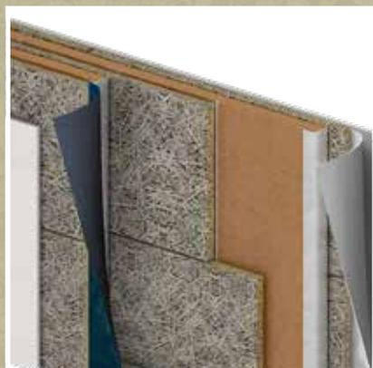
Isolamento su struttura a telaio
