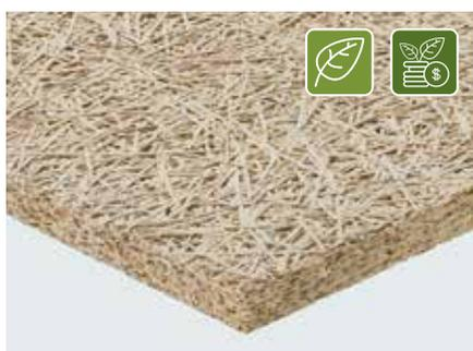
Pannello isolante termico ed acustico, in lana di legno sottile di abete rosso mineralizzata e legata con cemento Portland bianco. Larghezza lana di legno: 2 mm. Pannelli di alta qualità per sistemi di design e assorbimento acustico. Conforme alla norma UNI EN 13168 e UNI EN 13964. Certificato da ANAB-ICEA e natureplus per la ecocompatibilità dei materiali e del processo produttivo. CELENIT AB è certificato PEFC™. Disponibile anche con certificazione FSC®.
