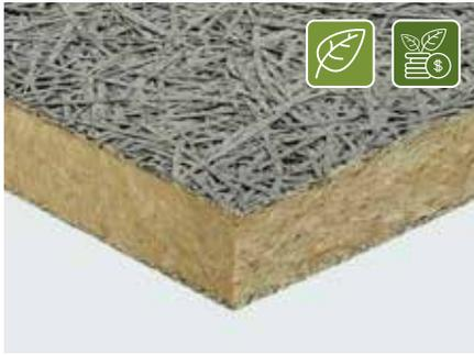
Pannello isolante termico ed acustico composito, specifico per applicazione a cappotto, costituito da due strati (spessore 5 mm ciascuno) in lana di legno di abete rosso mineralizzata e legata con cemento Portland grigio, accoppiato ad uno strato interno di lana di roccia ad alta densità, conforme alla norma UNI EN 13162. Conforme alla norma UNI EN 13168. CELENIT L3/C è certificato PEFC™. Disponibile anche con certificazione FSC®.
