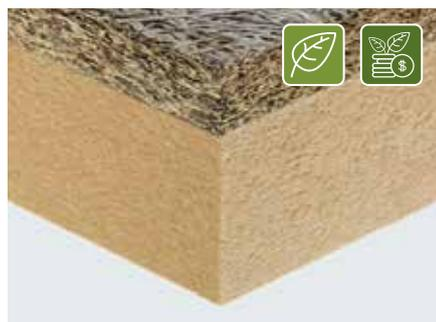
Pannello isolante termico ed acustico composito, costituito da uno strato in lana di legno di abete rosso mineralizzata e legata con cemento Portland grigio, spessore 50 mm, accoppiato ad uno strato di fibre di legno conforme alla norma UNI EN 13171. Conforme alla norma UNI EN 13168. CELENIT F2 è disponibile con certificazione FSC®.
