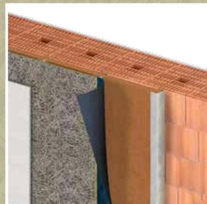
Isolamento con rivestimento interno
