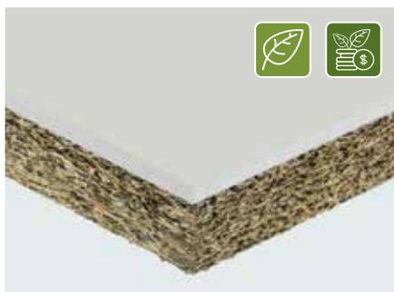
Pannello isolante termico ed acustico composito, costituito da uno strato in lana di legno di abete rosso mineralizzata e legata con cemento Portland grigio, conforme alla norma UNI EN 13168, accoppiato ad una lastra in cartongesso antincendio spessore 12,5 mm, conforme alla norma UNI EN 520. CELENIT CG/F è certificato PEFC™. Disponibile anche con certificazione FSC®.
