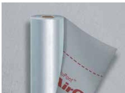
Barriera al vapore metallizzata per il controllo del vapore per tetti, pareti e pavimenti. Membrana, ermetica al 100% all'aria, con superficie a bassissima emissività che incrementa in modo significativo l'isolamento termico degli edifici.
