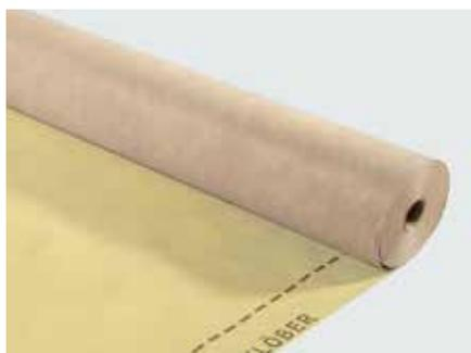
Freno al vapore (sd=3 m) a tre strati, da posizionare sul tavolato, sotto l'isolante, con resistenza meccanica elevata, doppia idrorepellenza, resistenza ai raggi UV, tenuta d'aria, calpestabile, antiscivolo. Prodotto con sistema HMCC.
